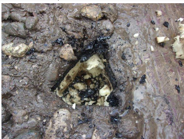
Composant : Revêtements et colles d'étanchéité 157 (N) bitumineux pare-vapeur
