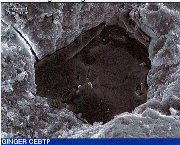
Photo n°19 Réf. : MEB Grain de type imbrulé
