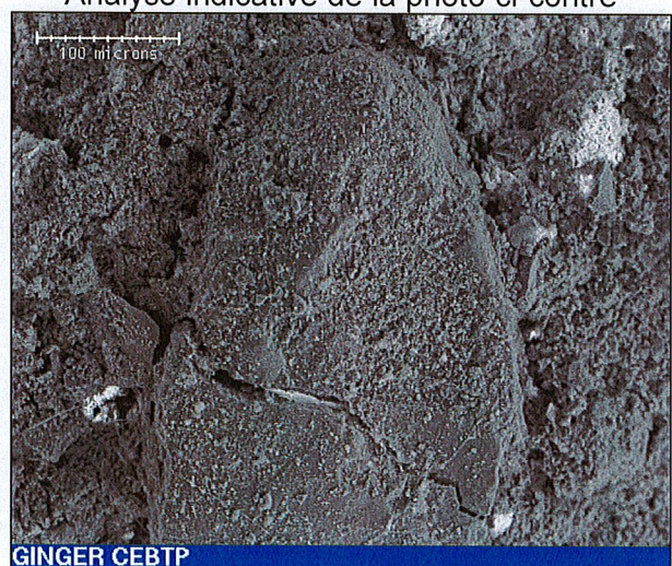
Photo n°5 Réf. : MEB Grain de sable dégagé
