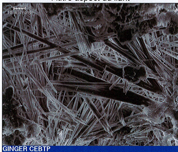
Photo n°10 Réf. : MEB Ettringite en aiguilles
