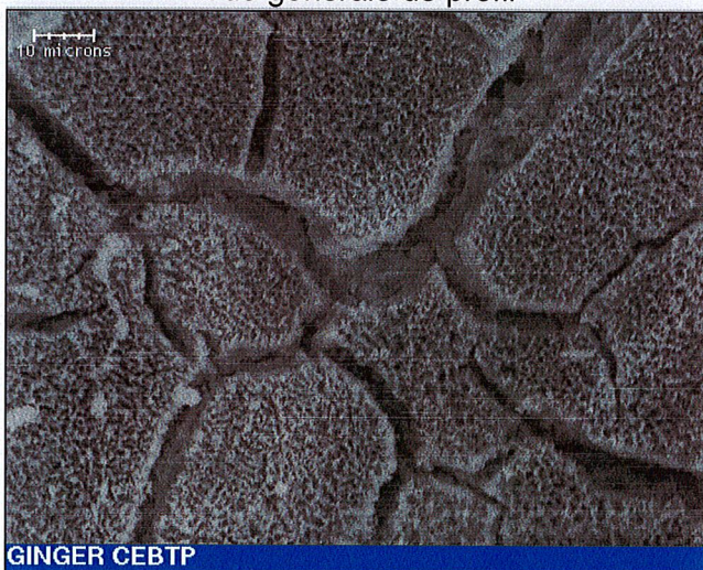
Photo n°3 Réf. : MEB Vue générale des zones craquelées
