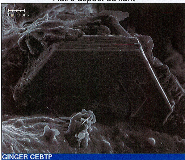
Photo n°14 Réf. : MEB Chaux hydratée en plaquettes
