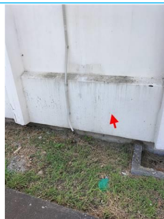
Matériaux : ZPSO-018 Prélèvement : P018 Description : Peinture sur béton moulurage blanc Localisation : Façade gauche Résultat : Absence d'amiante
