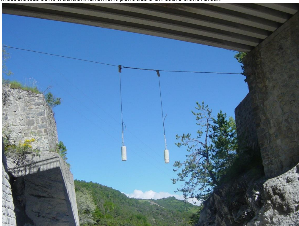
Système d'alerte RN - Détecteur de lave torrentielle – Pont du Marquisat
