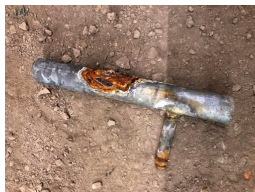
Échantillon de tube corrodé
