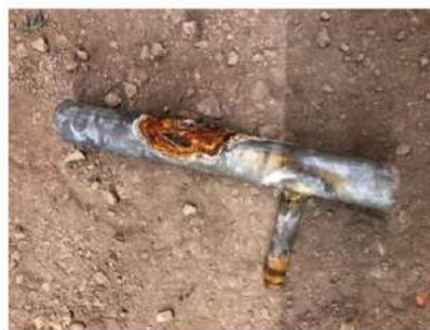
Échantillon de tube corrodé
