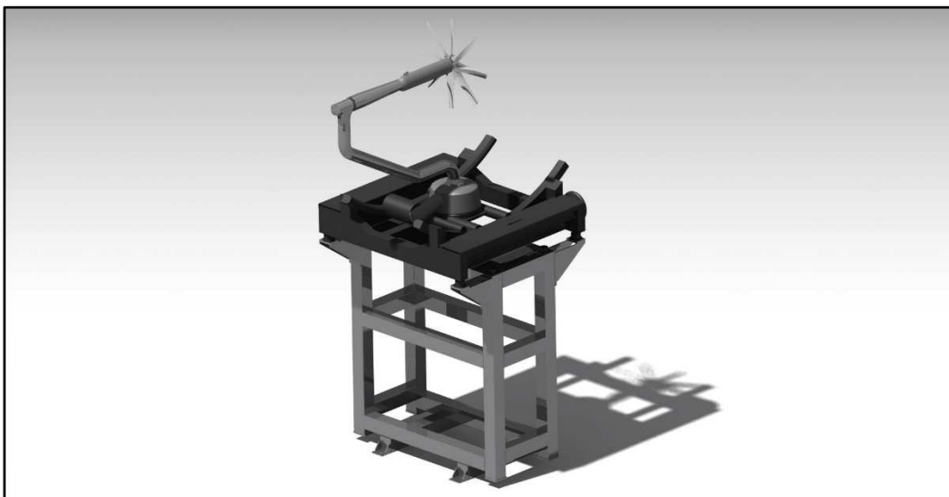
Fig. 1 : Banc hélice complet (avec montage hélice basse puissance)
