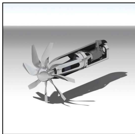
Fig. 3 : Montage hélice haute puissance
