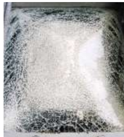
Test de résistance à une déflagration : EN 13541
