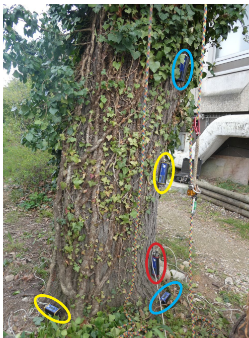
Photographie n°15 : Mise en place des capteurs. Traction Sud-Ouest
