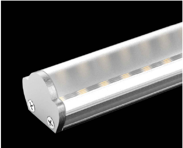
Rail LED - Longueurs variables de 500 à 3000 mm 10 à 15 W/m - 3000K - optique entre 30 et 60° Sur gradation et avec patte d'orientation
