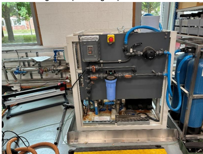
Exemple d'installation de production d'eau déionisée
