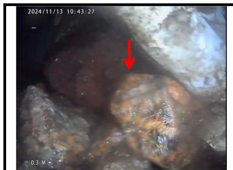
Photo 15 : au départ de B.B – obstruction par des gravats empêchant la progression de la caméra.
