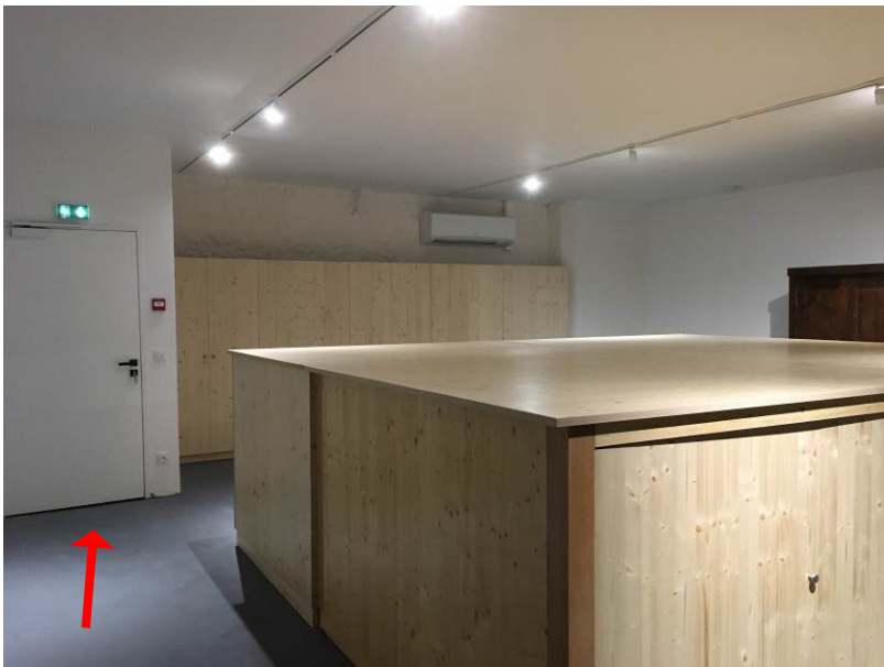
6. Porte coupe-feu 1/2 heure équipée d'un ferme-porte et d'un Bloc Autonome de Sécurité (BAES 45 lumens 1 heure).
