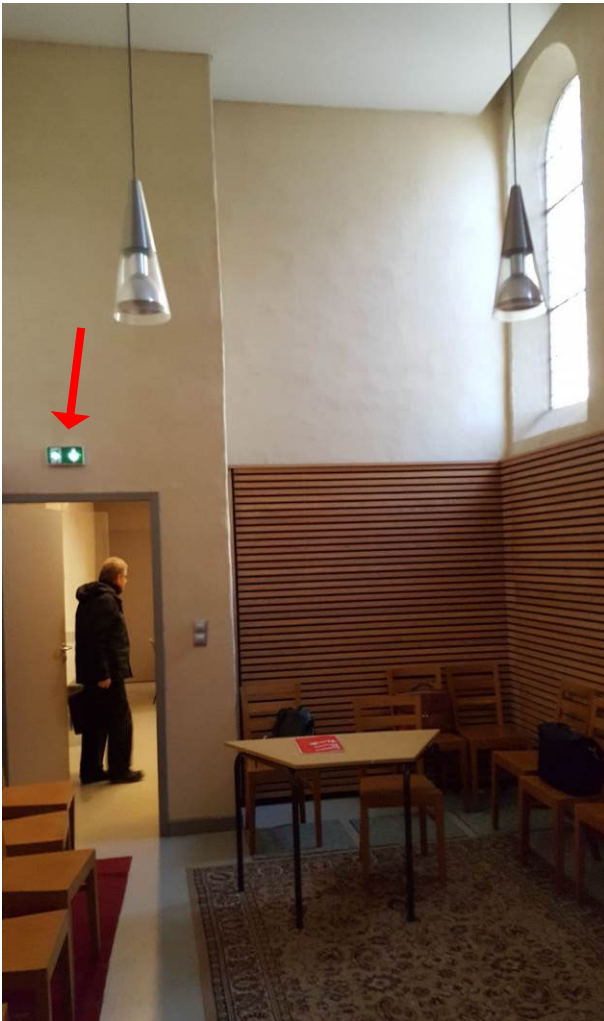
6. Bloc autonome de sécurité donnant vers l'issue de secours.
