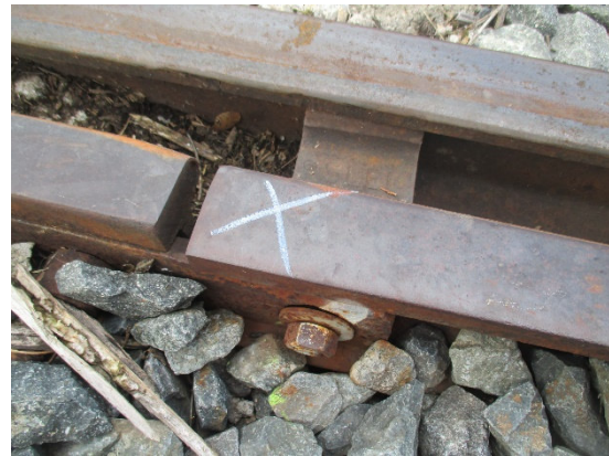
Boulon non conforme
