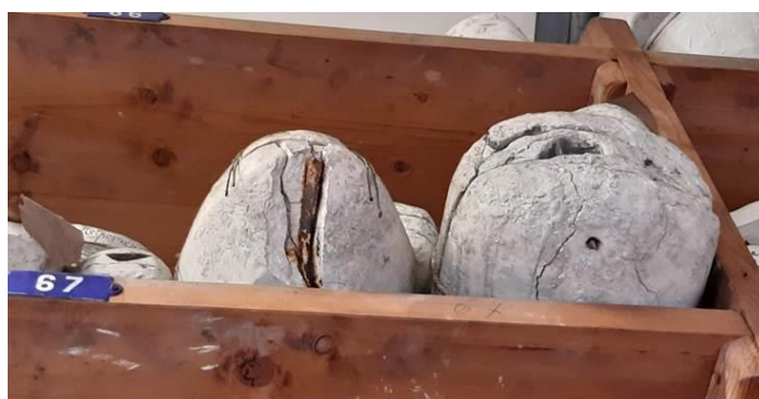
Salle C 67 - Différents stades de l'évolution des armatures métalliques corrodées
