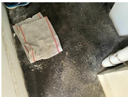
Matériaux : Z14 - Ensemble Bâtiment - Cellier - Sol - Chappe Prélèvement : P028 Description : chappe Localisation : Bâtiment 001 - Logement 003 - Cellier Résultat : Absence d'amiante
