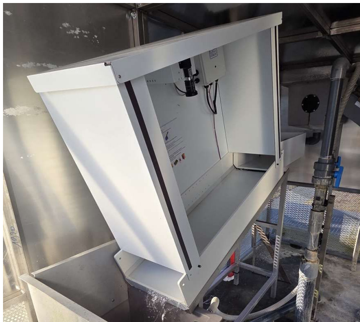
Figure 57 : Ouverture du capot latéral du compteur automatique pour le nettoyage de la rampe (©FISHPASS)
