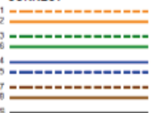
Schéma de câblage (T568B)
