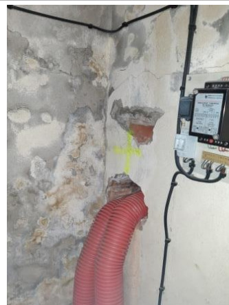
Prélèvement - P002 : Sous sol / Local Poste haute tension - Enduit- (Absence d'amiante)
