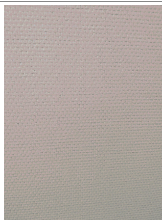
Prélèvement - P006 : R+1 / S 1.44 - Bande de plaque de plâtre- (Absence d'amiante)
