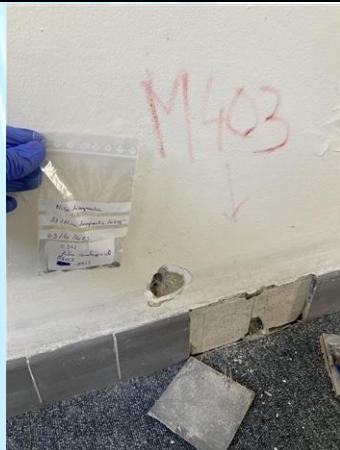
Photo n° PhA054 Localisation : MJA - MJA170 - NIVEAU : 03 - C341 - VACANT Ouvrage : 5 - Planchers et planchers techniques - Revêtements de sols Partie d'ouvrage : Colle de carrelage Description : PLINTHE - CARRELAGE + COLLE
