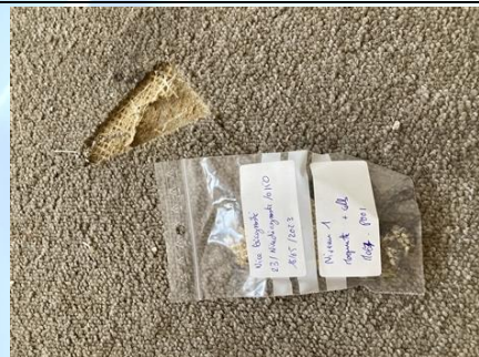
Photo n° PhA067 Localisation : MJA - MJA170 - NIVEAU : 01 - C134 - VACANT Ouvrage : 5 - Planchers et planchers techniques - Revêtements de sols Partie d'ouvrage : Moquette Description : Moquette + Colle
