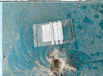
Photo n° PhA069 Localisation : MJA - MJA170 - NIVEAU : 01 - C112-14 - VACANT Ouvrage : 5 - Planchers et planchers techniques - Revêtements de sols Partie d'ouvrage : Dalle de sol Description : Dalle de sol + Colle
