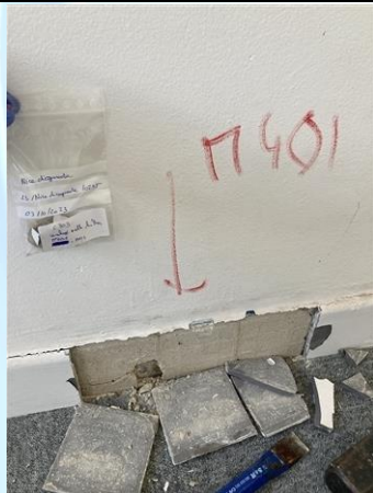
Photo n° PhA052 Localisation : MJA - MJA170 - NIVEAU : 03 - C303 - VACANT Ouvrage : 5 - Planchers et planchers techniques - Revêtements de sols Partie d'ouvrage : Colle de carrelage Description : PLINTHE - CARRELAGE + COLLE
