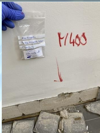
Photo n° PhA051 Localisation : MJA - MJA170 - NIVEAU : 03 - C301 - VACANT Ouvrage : 5 - Planchers et planchers techniques - Revêtements de sols Partie d'ouvrage : Colle de carrelage Description : PLINTHE - CARRELAGE + COLLE
