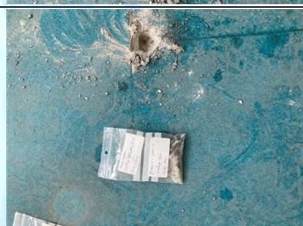
Photo n° PhA070 Localisation : MJA - MJA170 - NIVEAU : 01 - C112-14 - VACANT Ouvrage : 5 - Planchers et planchers techniques - Revêtements de sols Partie d'ouvrage : Colle de carrelage Description : Colle de carrelage gris
