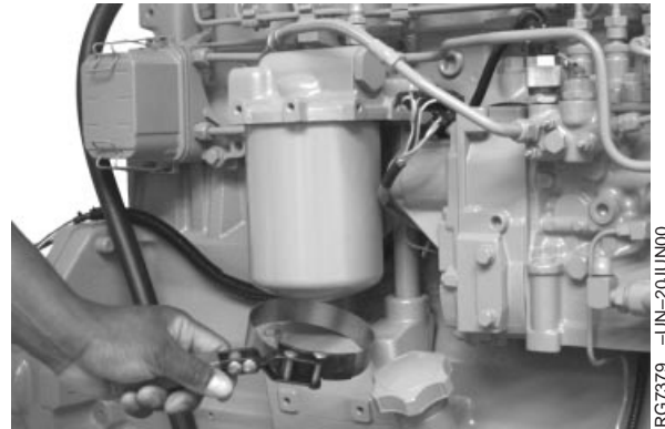
Remplacement du filtre à huile moteur
