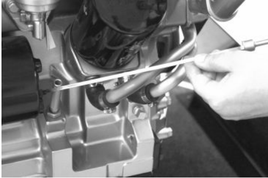
Vérification du niveau d'huile moteur
