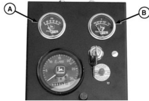
Manomètre d'huile et thermomètre du liquide de refroidissement (tableau de bord standard)
