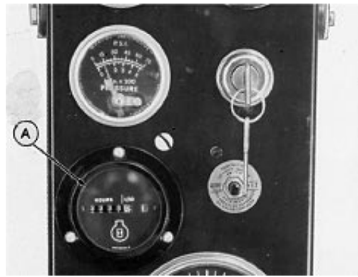
Compteur horaire (tableau de bord standard illustré)
