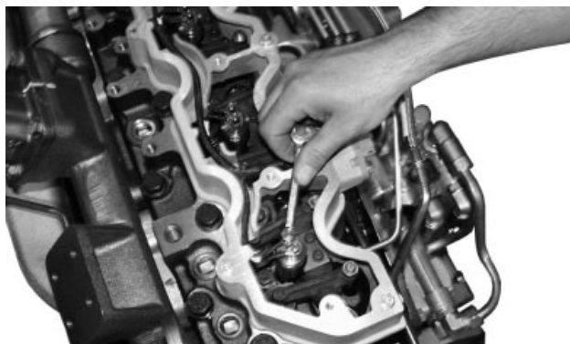
Pose d'écrous de retenue de fil de solénoïde sur les goujons d'injecteur
