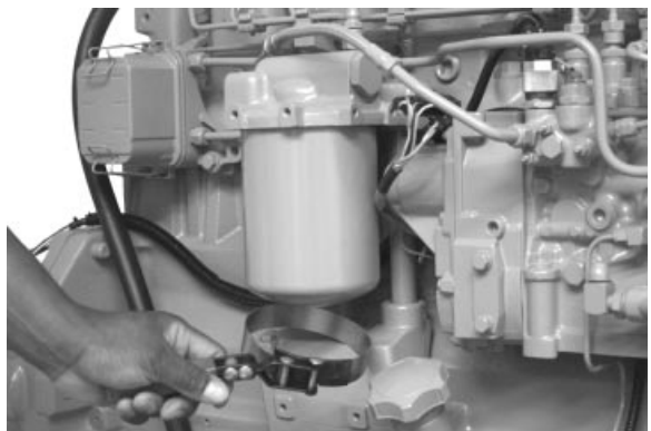
Remplacement du filtre à huile moteur—Moteurs ( —199,999) illustrés
