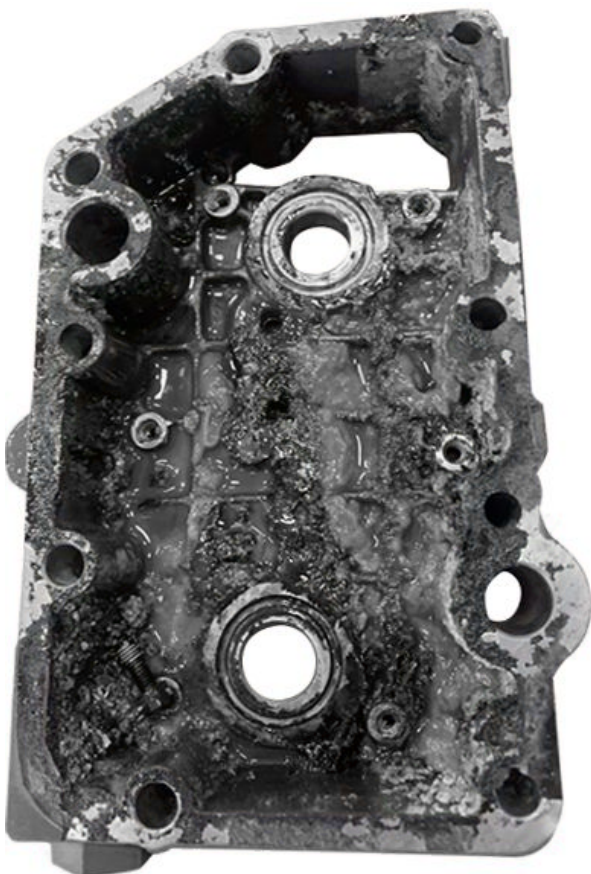
Effets du stockage prolongé du liquide de refroidissement—Plus d'une année
