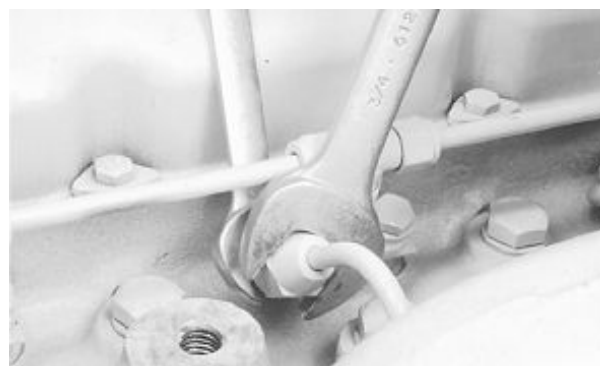
Purge du circuit d'alimentation au niveau de l'injecteur
