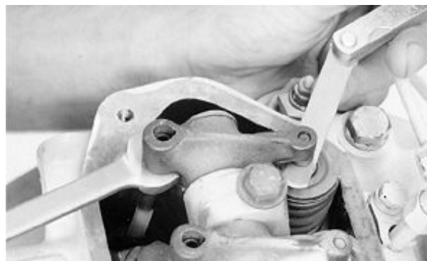
Contrôle du jeu des soupapes
