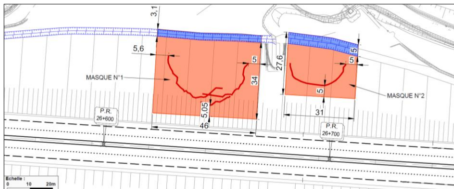
Figure 4. Emprises projetées des masques drainants à mettre en œuvre sur les talus du sens 2, de part et d'autre de l'OH 103
