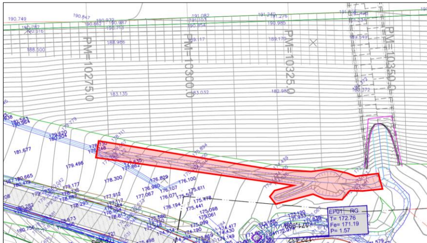
Figure 12. Vue en plan du fossé existant localisé en pied du talus du sens 2, entre les repères P.R. 26+675 et P.R. 26+745
