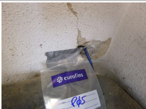
Prélèvement - P05 : Rez-de-chaussée / Local Chaudière - Enduit projeté- (Absence d'amiante)
