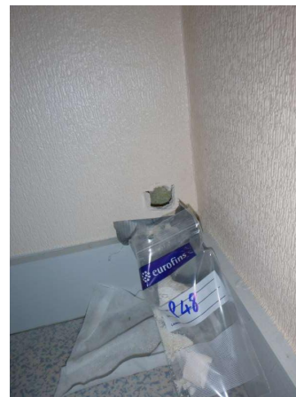
Prélèvement - P48 : 1er Etage / Bureau 8 - Panneau de cloison - (Absence d'amiante)
