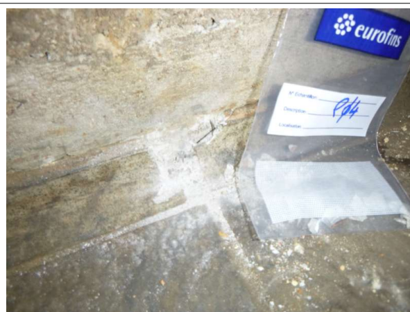
Prélèvement - P04 : Rez-de-chaussée / Local Chaudière - Colle de plinthe- (Absence d'amiante)
