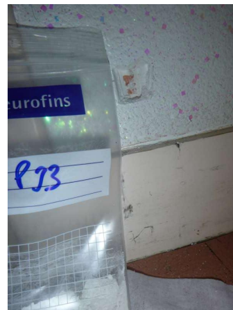
Prélèvement - P33 : Rez-de-chaussée / Bureau 5 - Enduit projeté- (Absence d'amiante)
