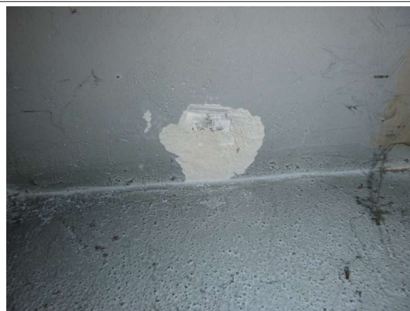
Prélèvement - P12 : Rez-de-chaussée / Local Chaudière - Enduit projeté- (Absence d'amiante)
