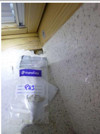
Prélèvement - P43 : 1er Etage / Salle de Réunion - Panneau collé ou vissé- (Absence d'amiante)
