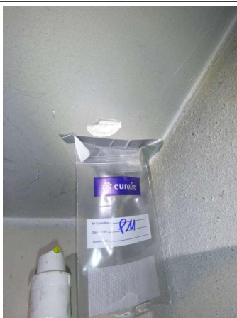
Prélèvement - P11 : Rez-de-chaussée / Local Chaudière - Enduit projeté- (Absence d'amiante)
