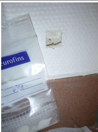
Prélèvement - P21 : Rez-de-chaussée / Hall et Dégagement 2 - Enduit projeté- (Absence d'amiante)
