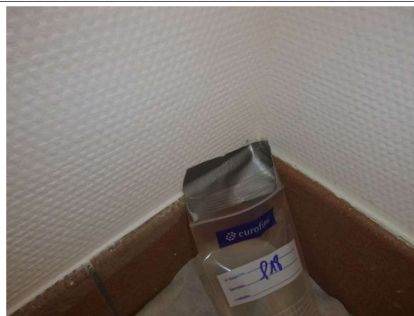
Prélèvement - P18 : Rez-de-chaussée / Hall et Dégagement 2 - Enduit projeté- (Absence d'amiante)
