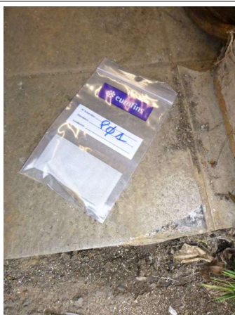
Prélèvement - P01 : Rez-de-chaussée / Local Chaudière - Colle de carrelage- (Absence d'amiante)
