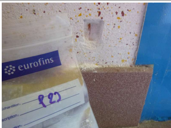
Prélèvement - P23 : Rez-de-chaussée / Sas d'Entrée 2 - Enduit projeté- (Absence d'amiante)
