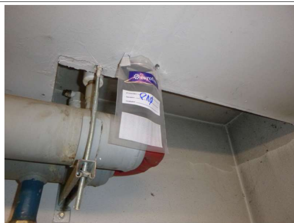
Prélèvement - P10 : Rez-de-chaussée / Local Chaudière - Bande de plaque de plâtre- (Absence d'amiante)
