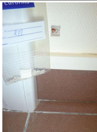
Prélèvement - P22 : Rez-de-chaussée / Bureau 1 - Enduit projeté- (Absence d'amiante)
