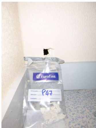
Prélèvement - P47 : 1er Etage / Bureau 8 - Panneau de cloison - (Absence d'amiante)
