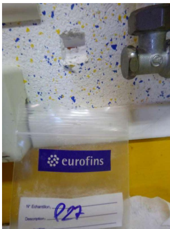
Prélèvement - P27 : Rez-de-chaussée / Local EPI - Enduit projeté- (Absence d'amiante)
