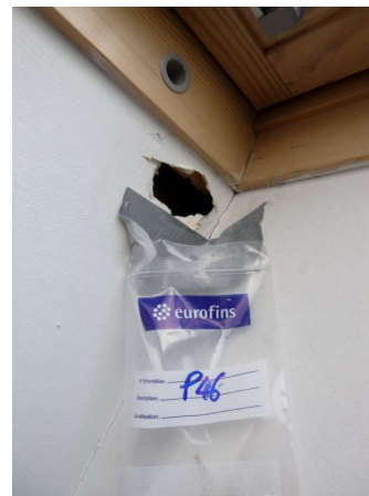
Prélèvement - P46 : 1er Etage / Bureau 8 - Panneau collé ou vissé- (Absence d'amiante)
