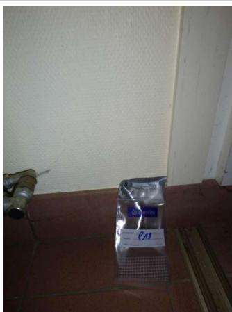
Prélèvement - P19 : Rez-de-chaussée / Bureau 4 - Enduit projeté- (Absence d'amiante)
