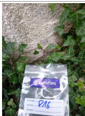
Prélèvement - P16 : Extérieurs / Façades - Enduit projeté- (Absence d'amiante)
