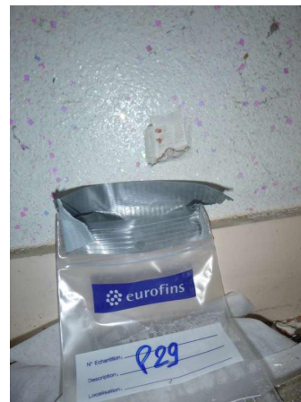
Prélèvement - P29 : Rez-de-chaussée / Bureau 5 - Enduit projeté- (Absence d'amiante)
