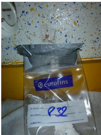
Prélèvement - P32 : Rez-de-chaussée / Local EPI - Enduit projeté- (Absence d'amiante)
