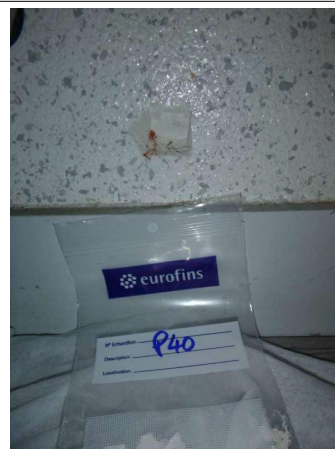
Prélèvement - P40 : 1er Etage / Salle de Réunion - Enduit projeté- (Absence d'amiante)
