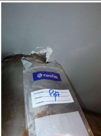
Prélèvement - P07 : Rez-de-chaussée / Local Chaudière - Panneau collé ou vissé- (Absence d'amiante)
