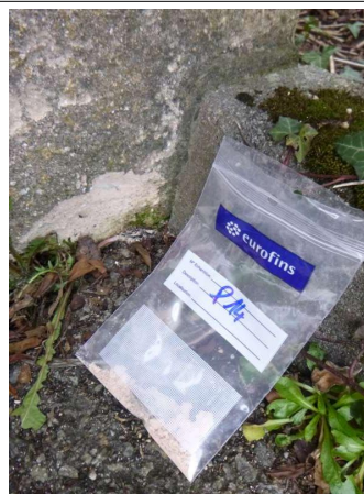
Prélèvement - P14 : Extérieurs / Façades - Enduit projeté- (Absence d'amiante)
