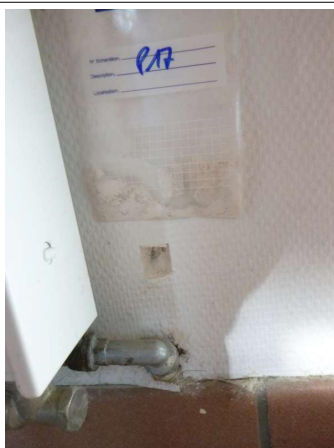
Prélèvement - P17 : Rez-de-chaussée / Hall d'Entrée 1 - Enduit projeté- (Absence d'amiante)
