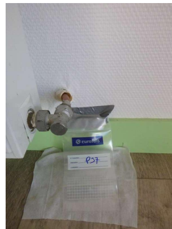
Prélèvement - P37 : Rez-de-chaussée / Bureau 6 - Enduit projeté- (Absence d'amiante)
