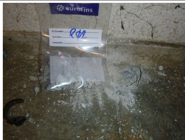
Prélèvement - P02 : Rez-de-chaussée / Local Chaudière - Colle de carrelage- (Absence d'amiante)
