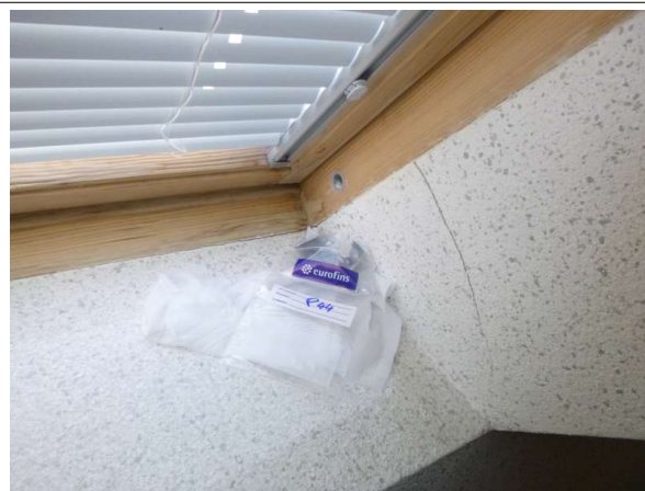
Prélèvement - P44 : 1er Etage / Salle de Réunion - Panneau collé ou vissé- (Absence d'amiante)
