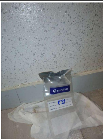
Prélèvement - P39 : 1er Etage / Salle de Réunion - Enduit projeté- (Absence d'amiante)
