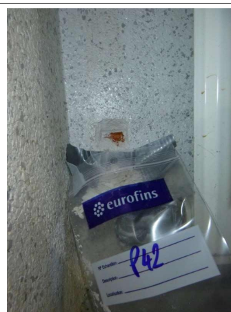
Prélèvement - P42 : 1er Etage / Hall 1er - Enduit projeté- (Absence d'amiante)
