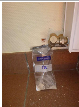
Prélèvement - P20 : Rez-de-chaussée / Bureau 1 - Enduit projeté- (Absence d'amiante)
