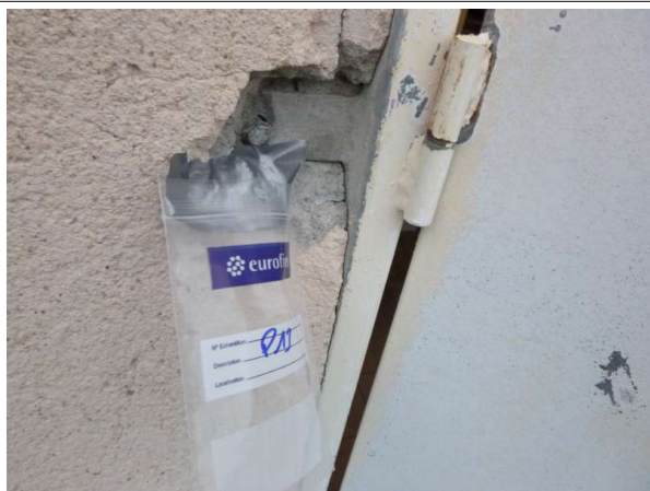
Prélèvement - P13 : Extérieurs / Façades - Enduit projeté- (Absence d'amiante)
