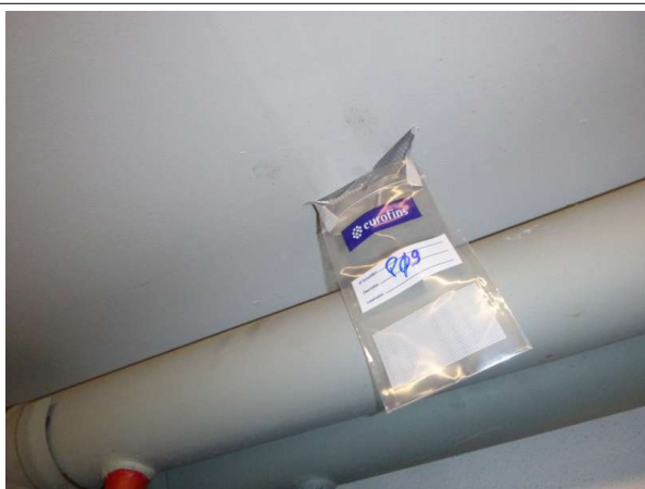
Prélèvement - P09 : Rez-de-chaussée / Local Chaudière - Bande de plaque de plâtre- (Absence d'amiante)
