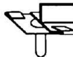
Fig. 5 Fixation par clip d'une lisse haute sur un faux-plafond
