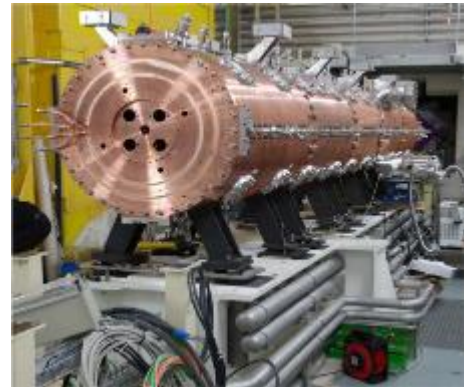
Figure 3 : Section de 2 types de cavité RFQ et cavité complète et intégrée sur sa ligne (RFQ SPIRAL 2 au GANIL)
