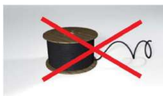
Les câbles non déroulés proprement sont vrillés et peuvent être dégradés lors de la pose
