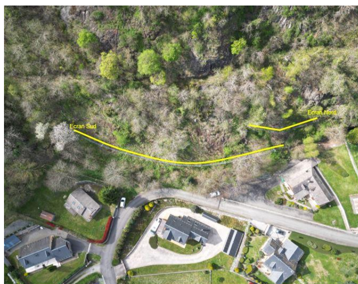
Implantation des 2 nouveaux ouvrages pare blocs
