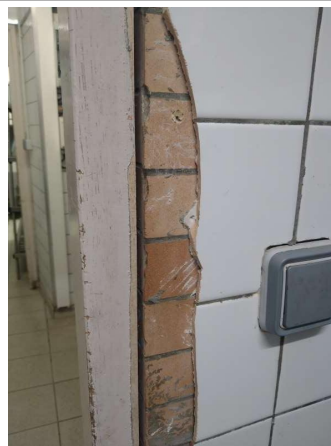
Prélèvement - P002 : BAT 0026 / RDC / LOCAL 09 - Colle de faïence- (Absence d'amiante)
