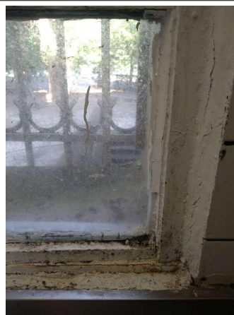
Prélèvement - P006 : BAT 0026 / RDC / LOCAL 08 - Mastic- (Absence d'amiante)
