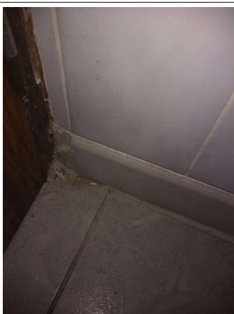
Prélèvement - P015 : BAT 0026 / RDC / LOCAL 10 - Colle de plinthe- (Absence d'amiante)
