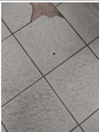
Prélèvement - P005 : BAT 0026 / RDC / LOCAL 09 - Colle de carrelage- (Absence d'amiante)
