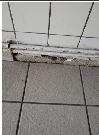
Prélèvement - P026 : BAT 0026 / R+1 / LOCAL 07A - Colle de plinthe- (Absence d'amiante)
