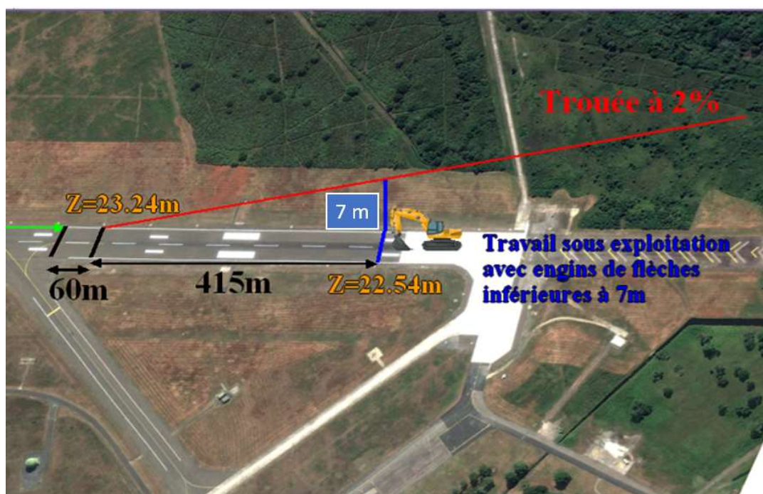
Figure 6 : Exploitation aéronautique durant les travaux dans la zone du seuil 06
