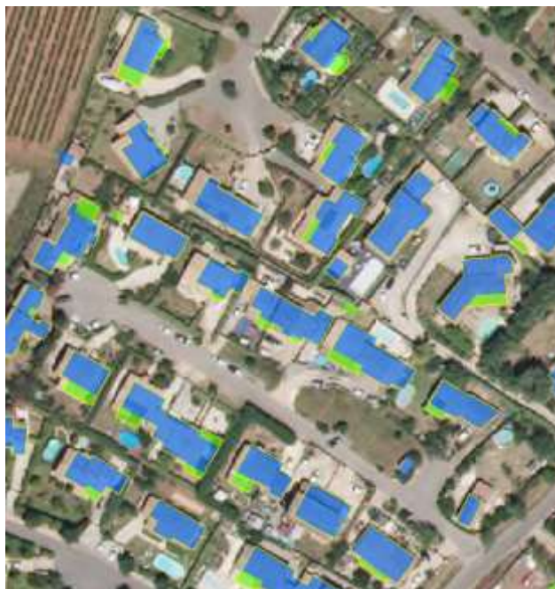
Exemple de fusion des annexes légères (en vert) avec les bâtiments durs (en bleu) auxquels elles sont accolées (l'enveloppe résultante est en contour jaune).
