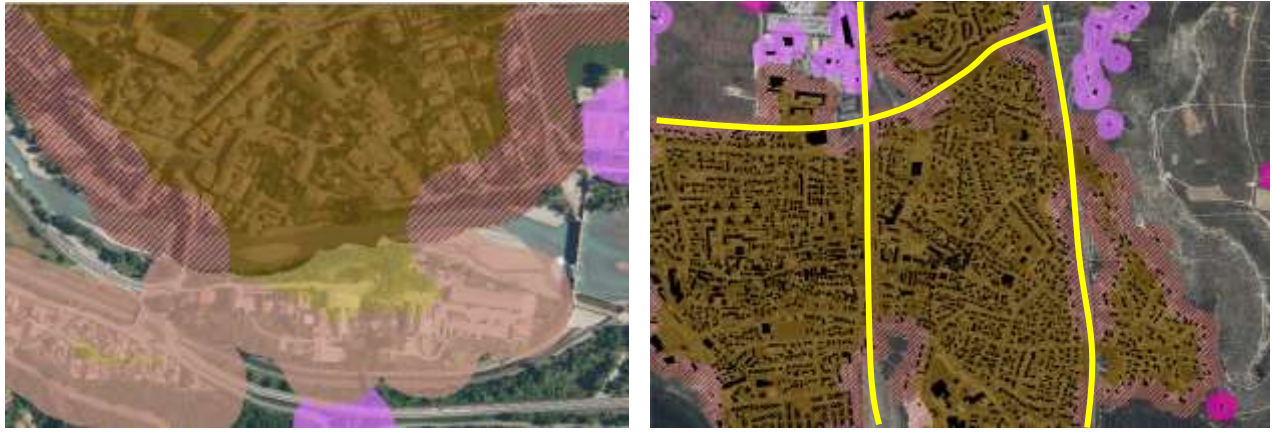
Exemples d'effet des grands axes : à gauche la rivière découpe 2 secteurs différents alors qu'ils sont connectés et peuvent être traités comme un seul espace urbanisé, et à droite les axes matérialisés en jaune (autoroutes et voie ferrée) créent une réelle déconnexion sur le terrain et justifieraient un traitement différent de certains espaces, notamment le quartier de droite qui ne présente pas la même organisation.
