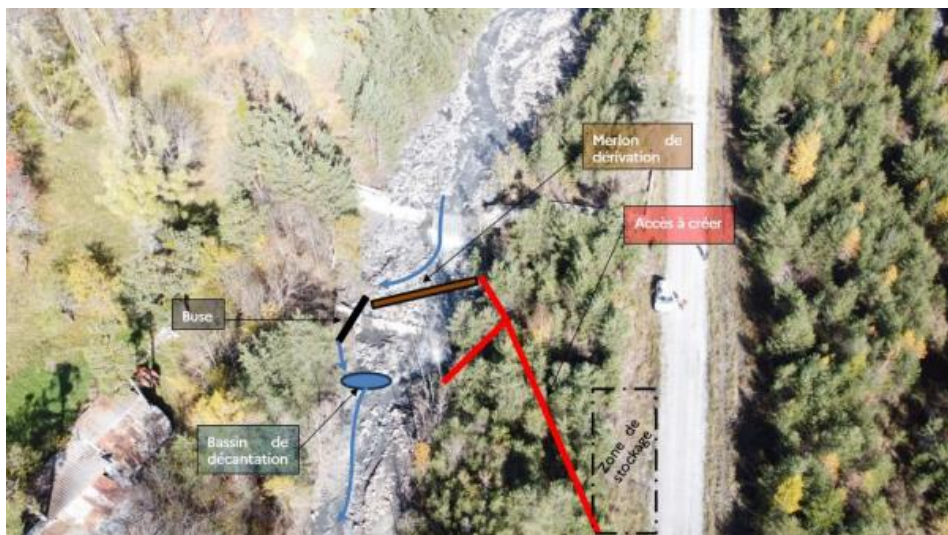
fig. 3 : Schéma de principe du plan de chantier.
