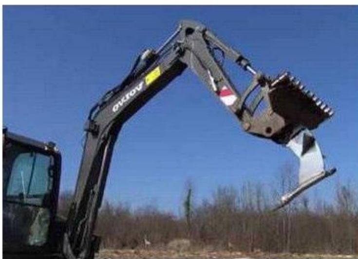
Illustration du sous-soleur multifonction monté sur midi-pelle.
