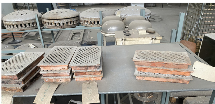
Figure 32 : Grilles en terre cuite modèles originaux déposés en conservation (réserves des HCL, ancien bâtiment des machines et chaudières) à réemployer ou à refaire fabriquer (suivant ce modèle) pour le pavillon A, photographies, Agence Goutal, 2024.
