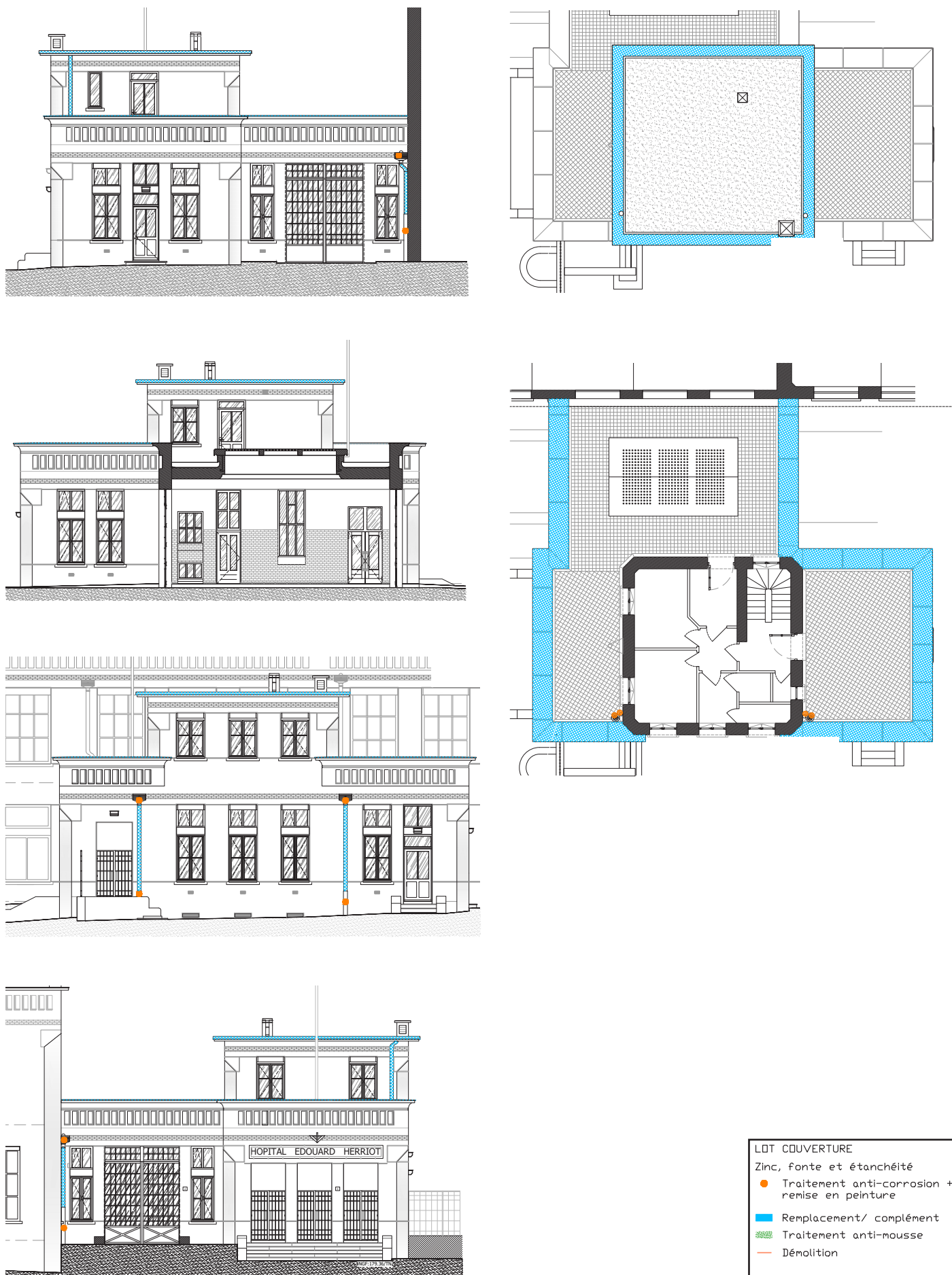
Figure 10 : État projeté (APD) du lot couverture, élévations, coupe-élévation et plans de niveaux, Agence Goutal, 2024.
