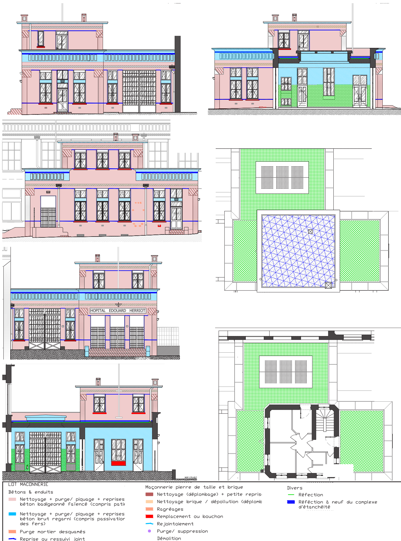
Figure 8 : État projeté (APD) du lot maçonnerie - pierre de taille et étanchéité, élévations et plans de niveaux, Agence Goutal, 2024.
