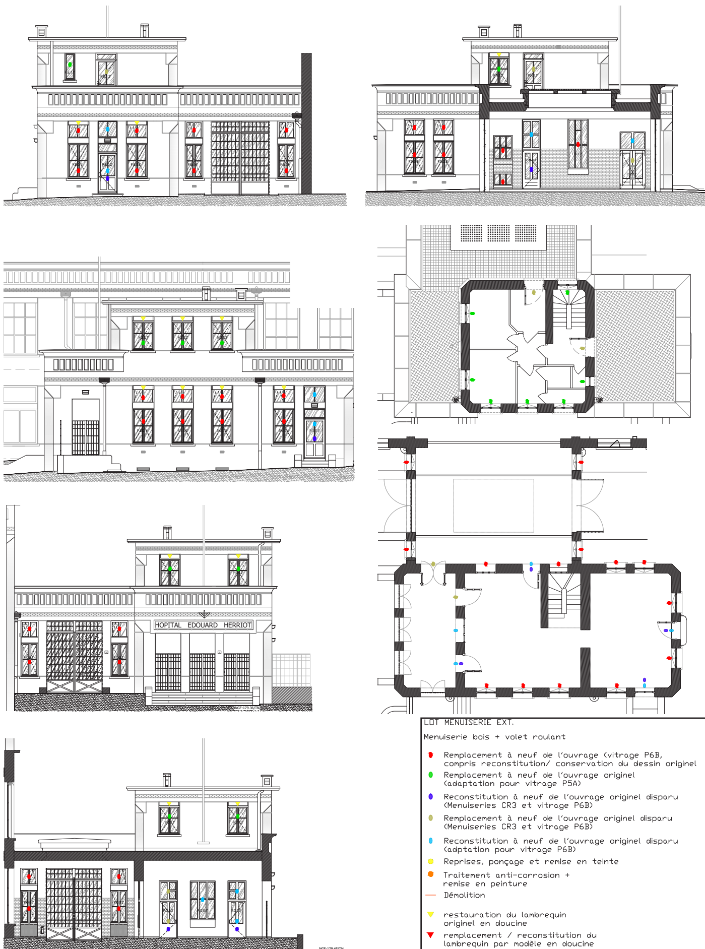
Figure 11 : État projeté (APD) du lot menuiseries extérieures, élévations, coupe-élévation et plans de niveaux, Agence Goutal, 2024.
