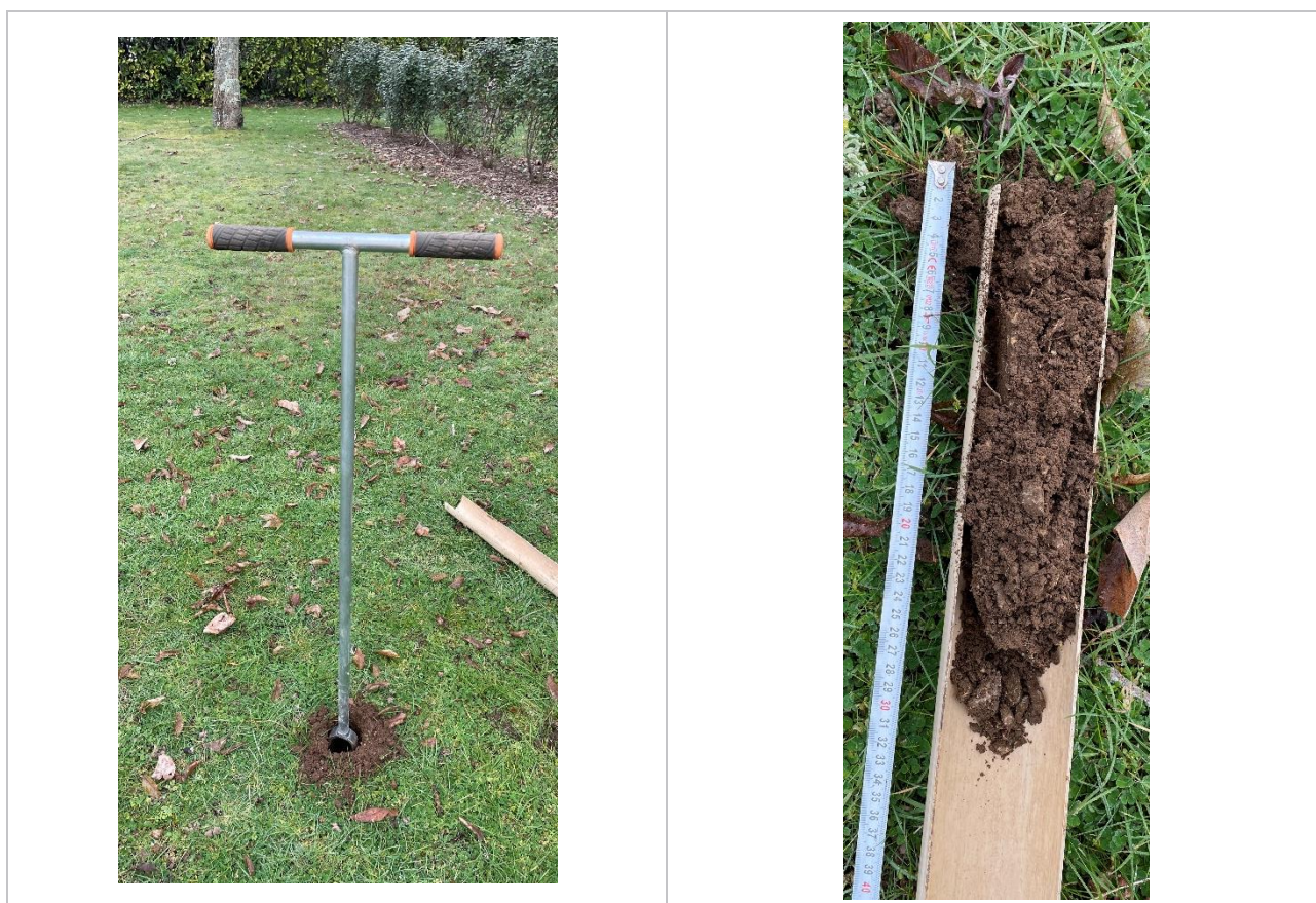
Illustration 18 : Photographies du sondage 10
