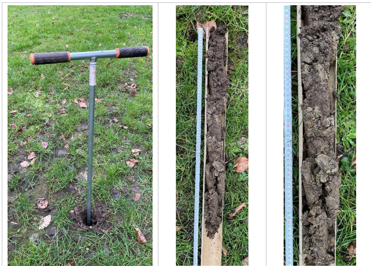
Illustration 24 : Photographies du sondage 16
