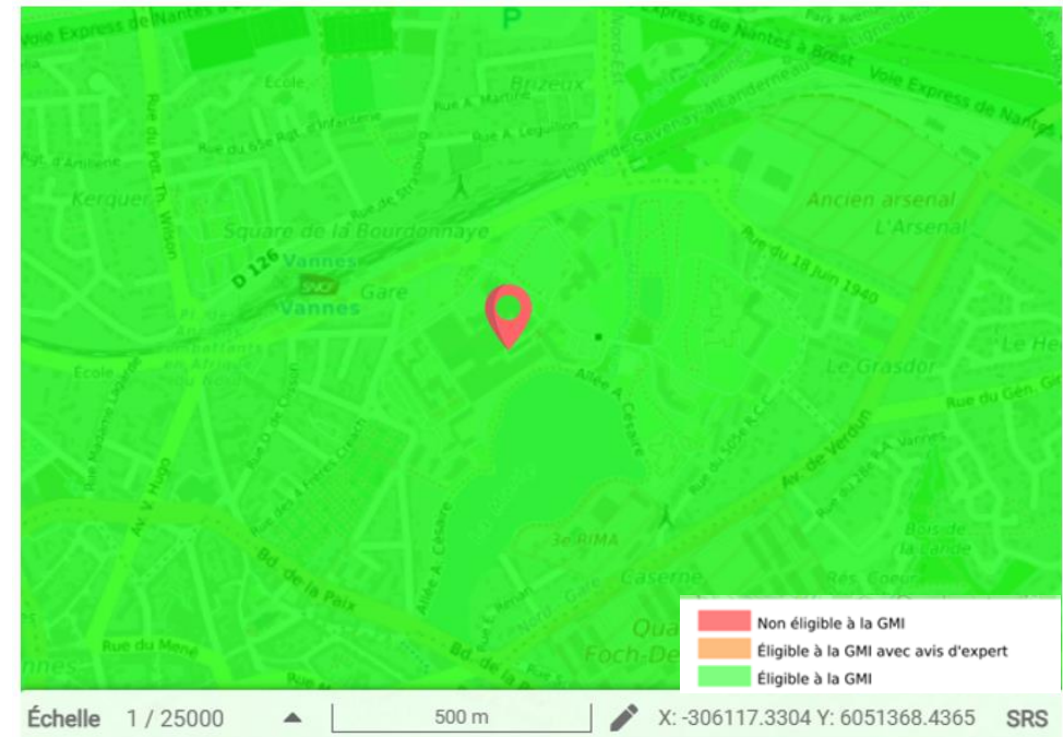
Figure 6 : Carte de zonation de la GMI sur les échangeurs géothermiques fermés (sondes) entre 100 et 200m de profondeur
