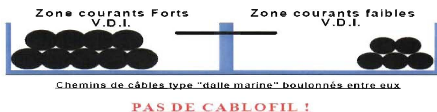
Figure 16 : Implantation type des câbles dans les chemins de câbles
