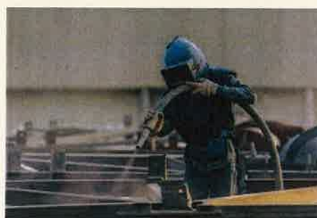
Photo 13: décapage chimique
