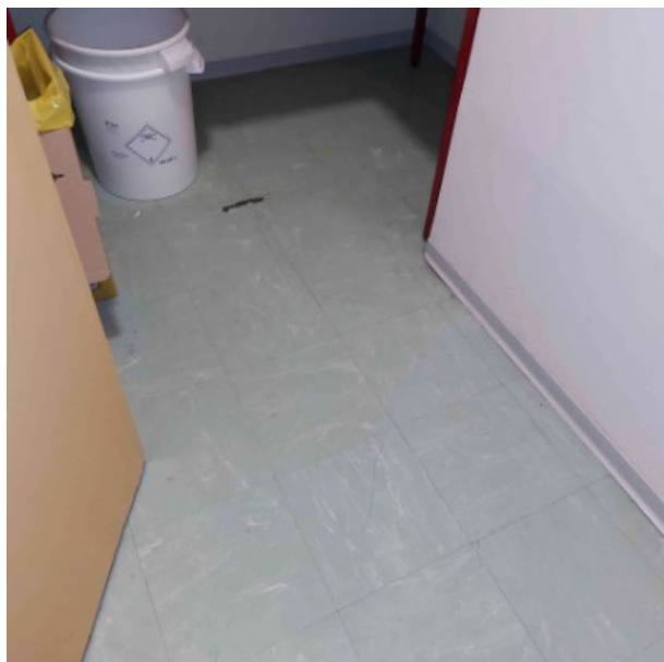
N REZ DE CHAUSSEE / Pièce Z2-15 / Dalle de sol vert clair + colle + ragréage [ Prélèvement n°17]
