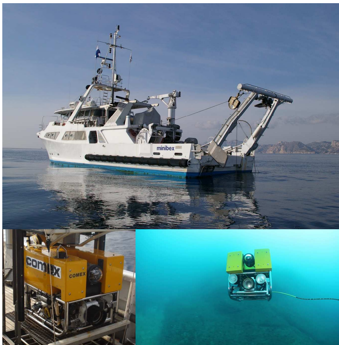
Figure 20 : Photos des équipements de l'exploration ROV. Le Minibex en mer avec le ROV en œuvre, le ROV dans sa cage avant immersion, le ROV en immersion.
