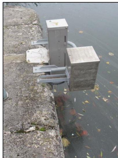
Figure 30 : Sonde de niveau / compteur entrée-sortie des bateaux type
