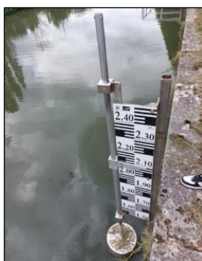
Figure 36 : Vue d'une échelle limnimétrique type (à flotteur)
