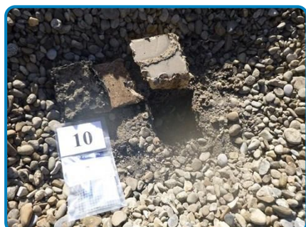
Prélèvement n° 10 : Complexe d'étanchéité Etanchéité supérieure (dans Extérieur Terrasse étage 2)
