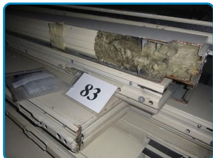
Prélèvement n° 83 : Panneaux CLESTRA HAUSSMANN Laine de verre intérieure (dans Sous-sol Pièce 1S1036)
