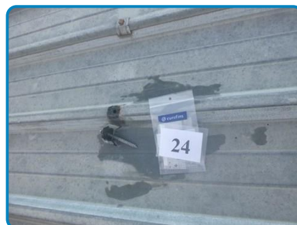
Prélèvement n° 24 : Tirefonds Étanchéité (dans Extérieur Toit niveau 5)
