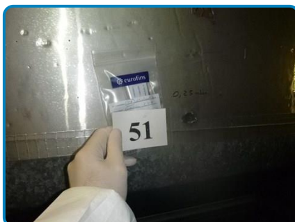
Prélèvement n° 51 : Isolant des gains CTA Laine de verre (dans Sous-sol Chaufferie 1S1016)
