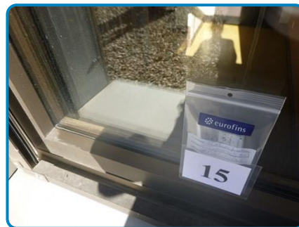
Prélèvement n° 15 : Fenêtre bois / alu Mastic côté alu (dans 2ème étage Dégagement 102029)
