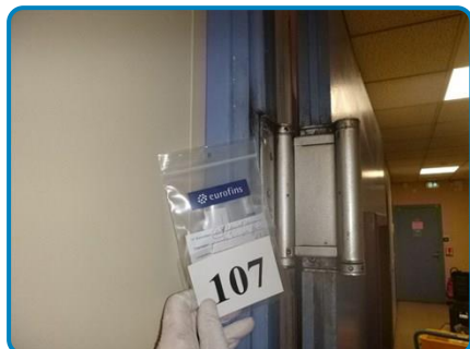
Prélèvement n° 107 : Porte coupe feu Joint (dans 2ème étage Circulation 102001)
