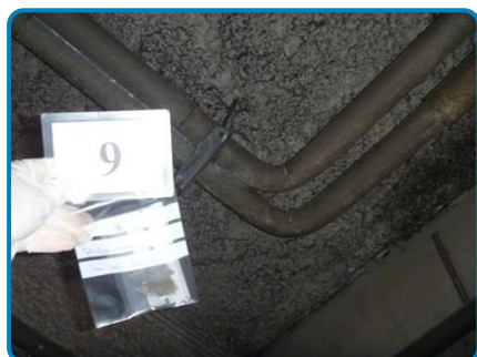
Prélèvement n° 9-D3 : Calorifuge Mousse (dans Sous-sol TGBT 1S1032)
