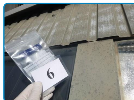
Prélèvement n° 6 : Panneau solaire Peinture noire intérieure (dans Extérieur Terrasse étage 2)
