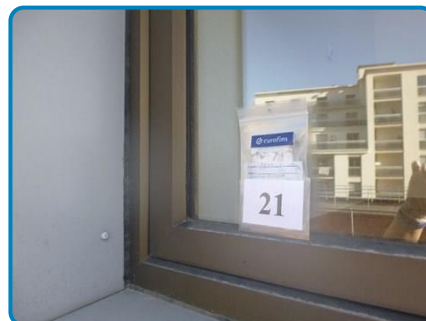
Prélèvement n° 21 : Menuiserie Mastic de vitrage (dans 2ème étage Escalier 102001)
