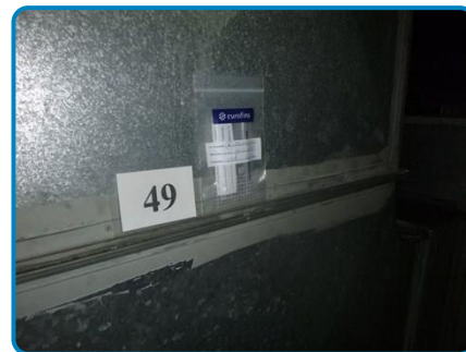
Prélèvement n° 49 : Gaine métal CTA Mastic gris (dans Sous-sol Chaufferie 1S1016)
