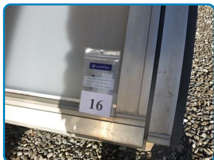
Prélèvement n° 16 : Lanterneau Joint périphérique caoutchouc (dans Extérieur Terrasse étage 2)
