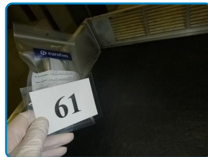
Prélèvement n° 61 : Ventilo-convecteur Isolant intérieur laine de verre + feutre noir (dans Sous-sol Chaufferie 1S1016)
