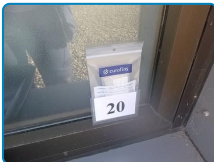
Prélèvement n° 20 : Menuiserie opaque Mastic de vitrage (dans 2ème étage Sanitaires 102029)
