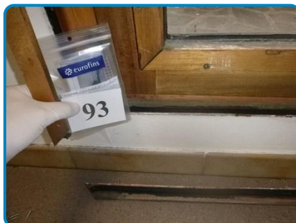
Prélèvement n° 93 : Jonction mousse / menuiserie Joint d'étanchéité (dans Rez-de-chaussée Dégagement 100047)
