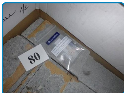
Prélèvement n° 80 : Carrelage grès 24x12 palier escalier Mortier de scellement (dans Sous-sol Local stock 1S1037)
