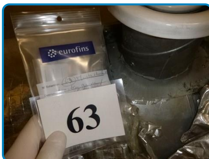
Prélèvement n° 63 : Gaine de ventilation métal Mastic d'étanchéité de jonction (dans Sous-sol Circulation 1S1022)
