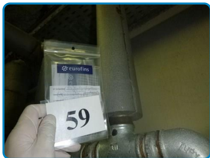
Prélèvement n° 59 : Circuit de chauffage Calorifuge mousse + colle (dans Sous-sol Chaufferie 1S1016)
