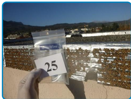
Prélèvement n° 25 : Toit ascenseur Étanchéité type paxalu (dans Extérieur Toit niveau 5)
