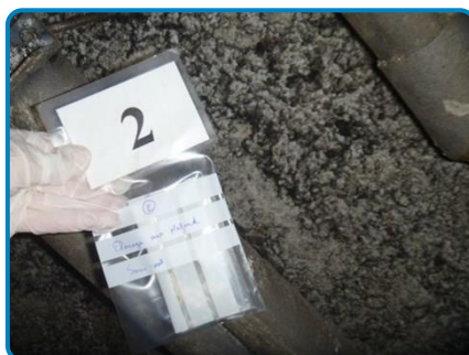
Prélèvement n° 2-D3 : Plafond Flocage (dans Sous-sol Onduleur 1S1031)
