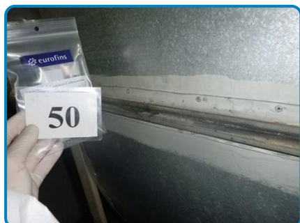
Prélèvement n° 50 : Gaine métal CTA Joint mousse de raccordement (dans Sous-sol Chaufferie 1S1016)
