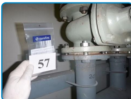
Prélèvement n° 57 : Circuit de chauffage Joint de bride (dans Sous-sol Chaufferie 1S1016)
