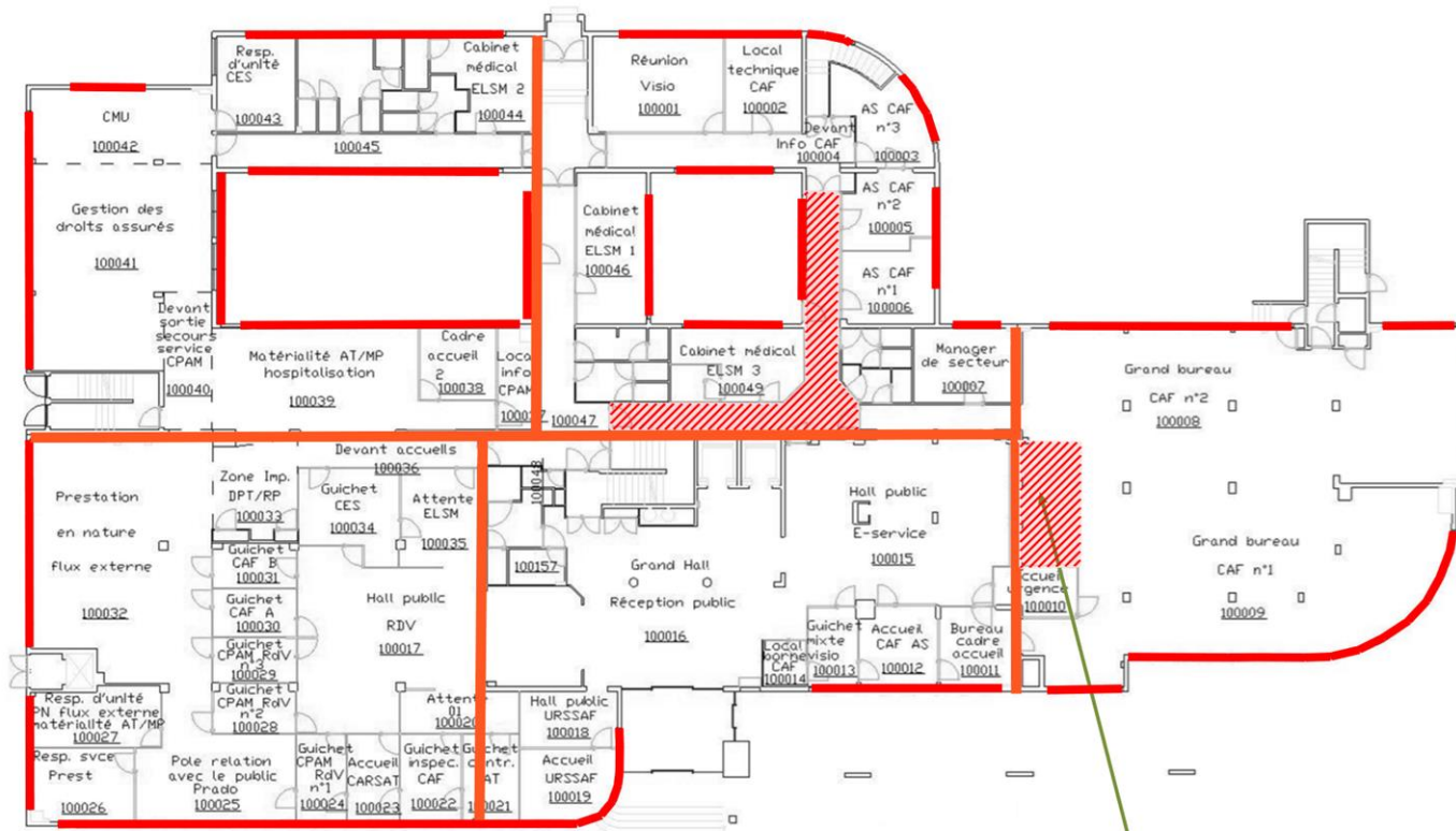
Mastic de vitrage amianté
