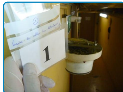
Prélèvement n° 1-D3 : Détecteur incendie Gaine des câbles (dans Sous-sol Stock mobilier 151002)
