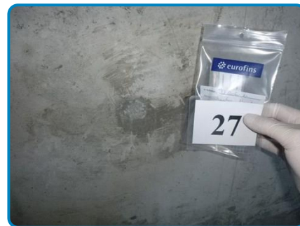
Prélèvement n° 27 : Mur Mortier de rebouchage d'écarteur de banche (dans 5ème étage Comble)
