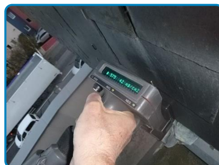
Bavette étanchéité sur garde corps maçonné Plomb (dans 4ème étage Terrasse)
