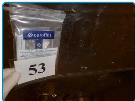
Prélèvement n° 53 : Gaine de ventilation CTA Colle de complexe alu / laine de verre (dans Sous-sol Circulation 1S1001)
