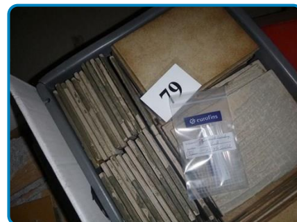
Prélèvement n° 79 : Carrelage hall 22x16 beige Joint (dans Sous-sol Local stock 1S1037)
