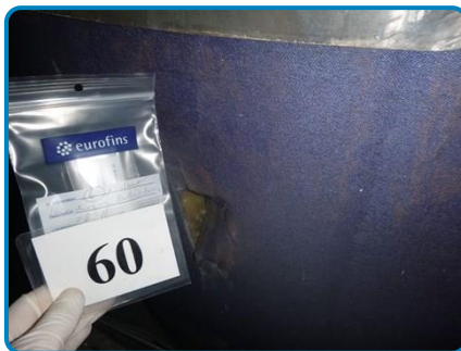
Prélèvement n° 60 : Ballon solaire Isolant laine de verre (dans Sous-sol Chaufferie 1S1016)
