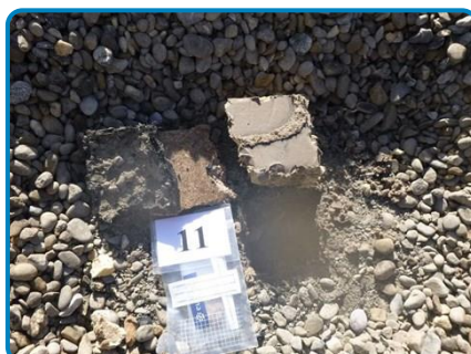
Prélèvement n° 11 : Complexe d'étanchéité Feutre fibreux (sous étanchéité supérieure) (dans Extérieur Terrasse étage 2)
