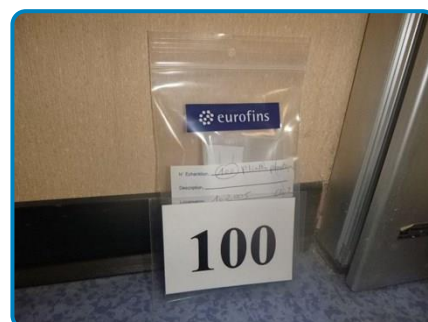
Prélèvement n° 100 : Mur Plinthe plastifiée (dans 2ème étage Action sociale CAF 2 102005)
