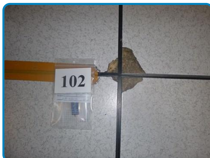
Prélèvement n° 102 : Plancher couche supérieure Dalle grise sur plot (dans 2ème étage Recouvrement CPAM - CAF 102030)
