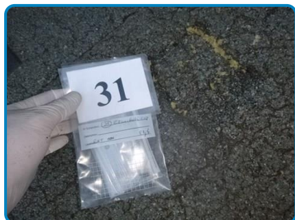
Prélèvement n° 31 : Complexe d'étanchéité Étanchéité supérieure (dans Extérieur Terrasse niveau 4)
