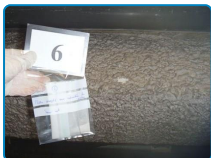
Prélèvement n° 6-D3 : Poutre en plafond Flocage (dans Sous-sol Espace 1S1041)
