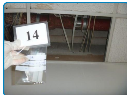
Prélèvement n° 14-D3 : Traversée de mur banché Enduit (dans 1er étage Dégagement)
