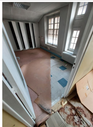
Prélèvement - P006 : R+1 / Bureau - Dalle de sol- (Présence d'amiante)
