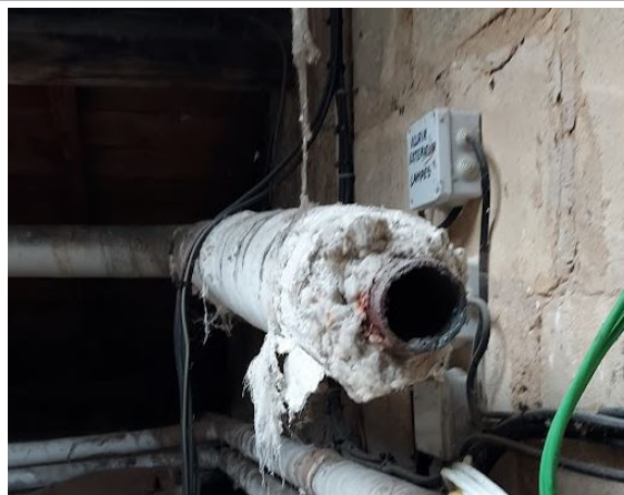
Prélèvement - P012 : R+1 / Comble 1 - Enveloppe de calorifuge - (Présence d'amiante)
