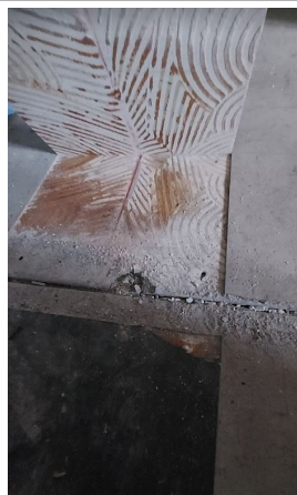
Prélèvement - P017 : R+2 / Couloir - Plaque- (Présence d'amiante)
