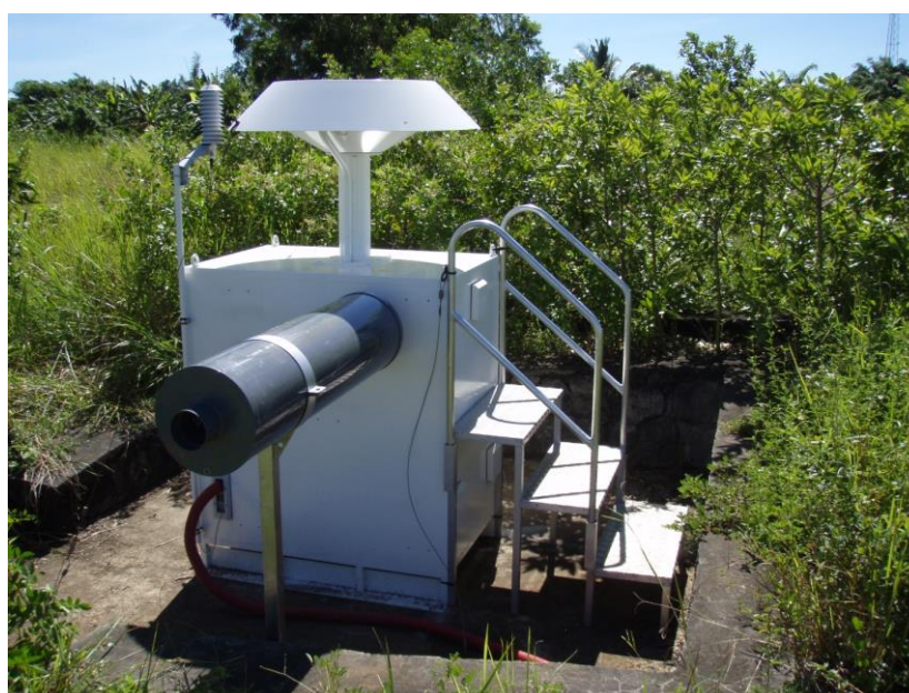
Figure 2 : Vue du préleveur atmosphérique (FRP29)
