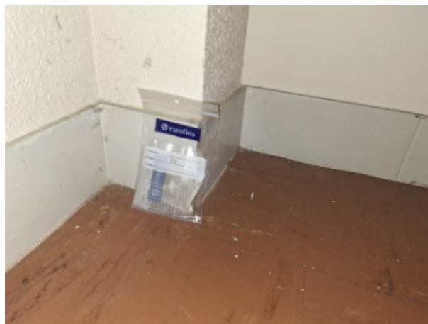
N R+2 / ZONE 3 / Colle de plinthe [ Prélèvement n°18]
