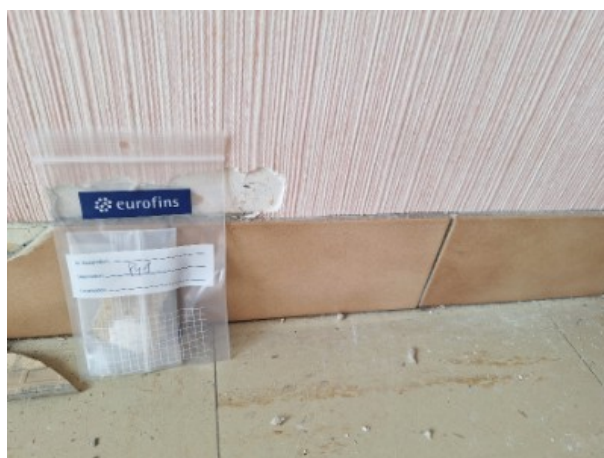
N R+2 / ZONE 18 / Colle de plinthe [ Prélèvement n°41]
