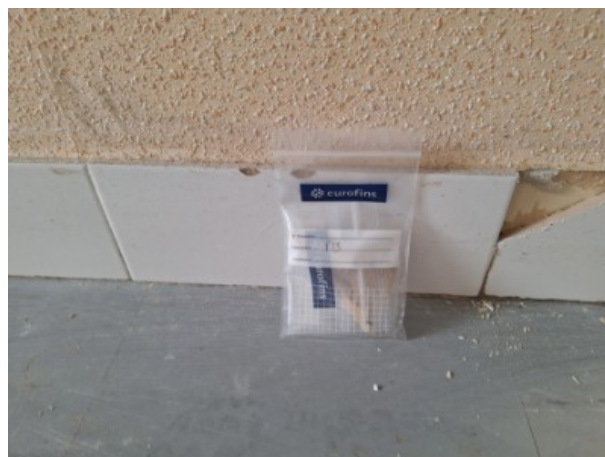
N R+2 / ZONE 7 / Colle de plinthe [ Prélèvement n°33]
