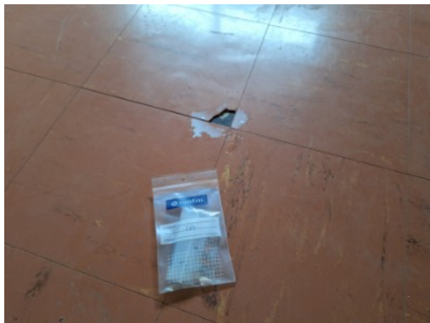
a R+2 / ZONE 3 / Dalle de sol rouge+colle [ Prélèvement n°17]
