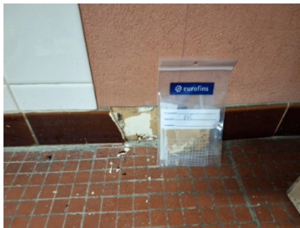
N R+2 / ZONE 32 / Colle de plinthe [ Prélèvement n°45]
