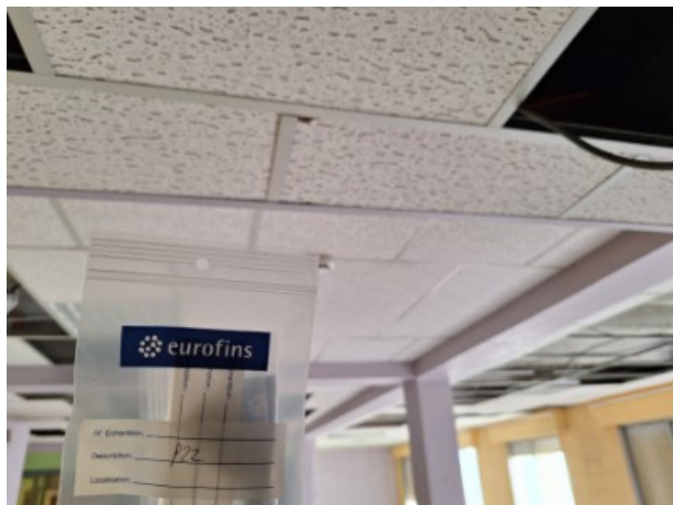
N R+2 / ZONE 4 / Dalle de faux plafond [ Prélèvement n°22]
