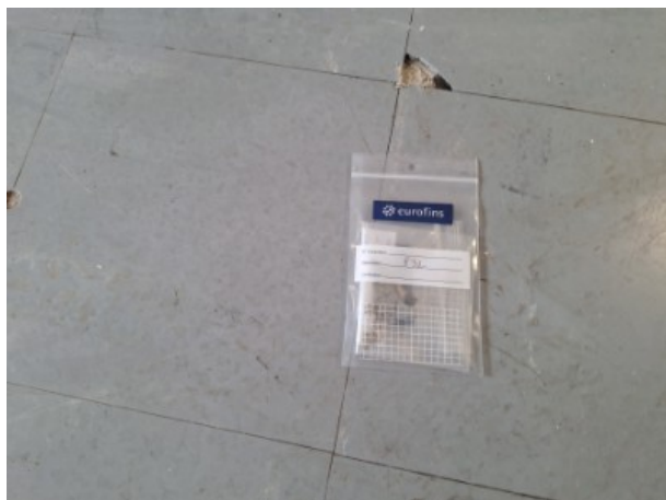
a R+2 / ZONE 7 / Dalle de sol grise+colle [ Prélèvement n°32]
