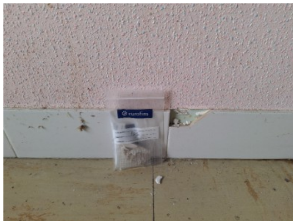
N R+2 / ZONE 26 / Colle de plinthe [ Prélèvement n°43]
