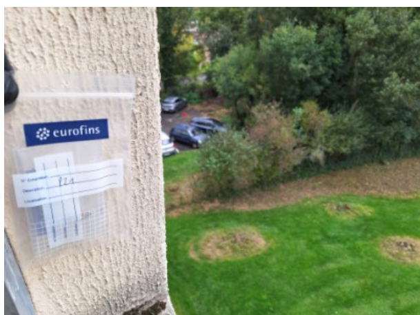
N R+2 / ZONE 4 / Enduit projeté [ Prélèvement n°21]
