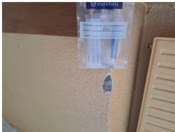
N R+2 / ZONE 4 / Enduit platre [ Prélèvement n°20]
