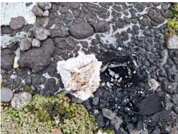
N R+3 / Toiture terrasse / Isolant [ Prélèvement n°2]
