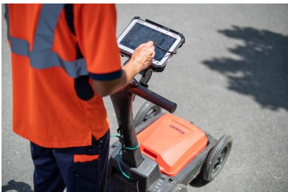
Figure 2 : Géoradar GSSI DF 300-800
