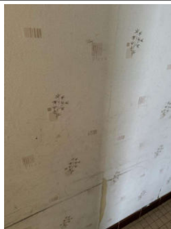
Prélèvement - P006 : R+1 / Entrée - Enduit- (Absence d'amiante)
