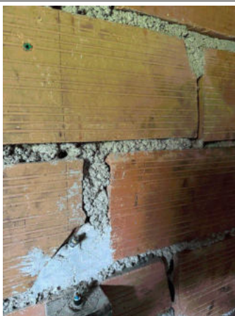
Prélèvement - P019 : Sous-sol / Garage - Joint- (Absence d'amiante)
