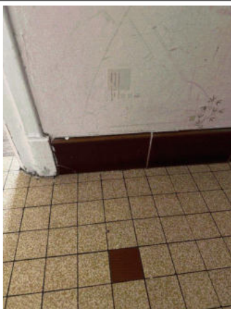
Prélèvement - P003 : R+1 / Entrée - Colle de plinthe- (Absence d'amiante)
