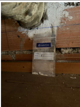
Déclaré - : Sous-sol / Garage - Enduit- (Absence d'amiante)
