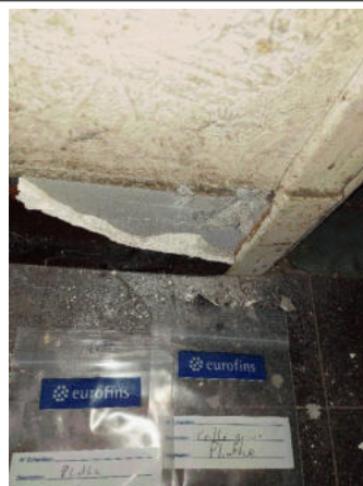
Prélèvement - P004 : RDC / Entrée - Colle de plinthe- (Absence d'amiante)
