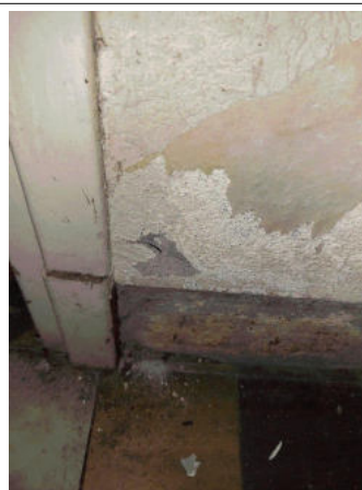
Prélèvement - P010 : RDC / Entrée - Enduit- (Absence d'amiante)
