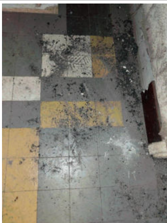
Prélèvement - P001 : RDC / Entrée - Colle de carrelage- (Absence d'amiante)
