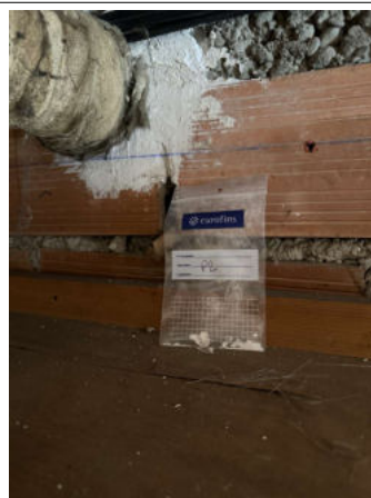
Déclaré - : Sous-sol / Garage - Enduit- (Absence d'amiante)
