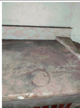
Prélèvement - P016 : RDC / Séjour - Colle de carrelage- (Absence d'amiante)
