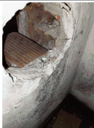
Prélèvement - P008 : RDC / Entrée - Enduit- (Absence d'amiante)
