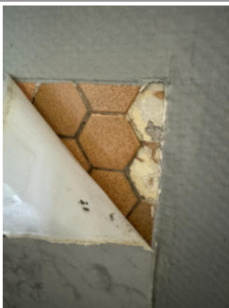
Prélèvement - P013 : R+1 / Cuisine - Colle de faïence- (Absence d'amiante)
