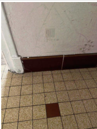
Prélèvement - P001 : R+1 / Entrée - Colle de carrelage- (Absence d'amiante)
