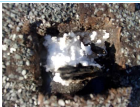
Matériaux : ZPSO-004 Prélèvement : P004 Description : Isolant Localisation : Toiture passerelle Résultat : Absence d'amiante Quantité :
