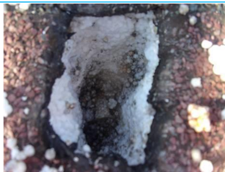
Matériaux : ZPSO-002 Prélèvement : P002 Description : Isolant Localisation : Toiture passerelle Résultat : Absence d'amiante Quantité :
