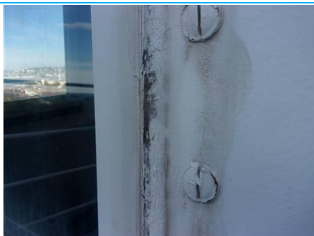
Matériaux : ZPSO-009 Prélèvement : P009 Description : Joint de menuiserie Localisation : Ensemble du 1er étage Résultat : Absence d'amiante Quantité :
