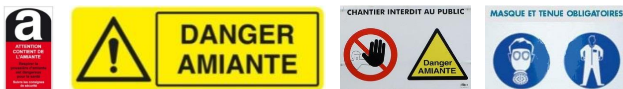
Figure 14 : Exemple de signalétique amiante
