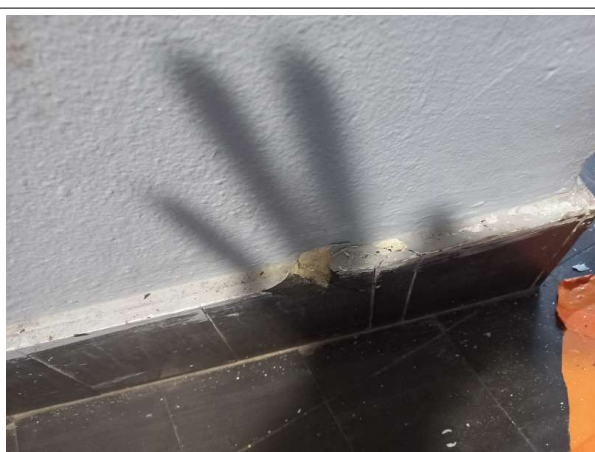
Prélèvement - P023 : MAISON D'ARRET / R+1 / ATTENTE PARLOIRS DETENUS - Colle de plinthe- (Absence d'amiante)
