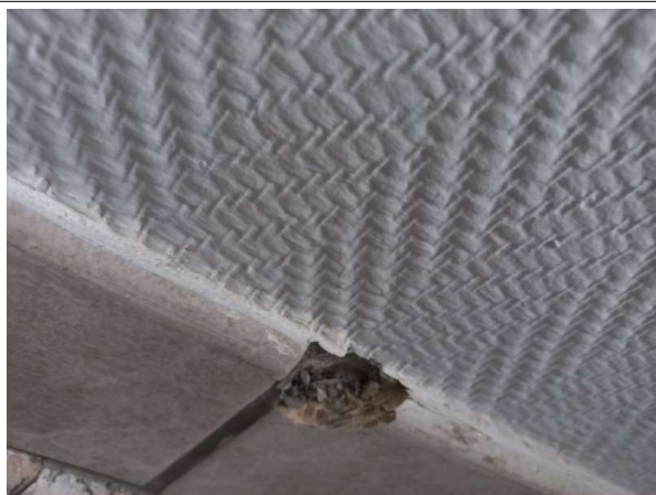
Prélèvement - P031 : MAISON D'ARRET / R+1 / LOCAL R.L.E - Colle de plinthe- (Absence d'amiante)
