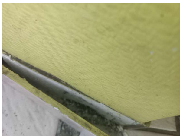
Prélèvement - P007 : MAISON D'ARRET / RDC / LOCAL ATTENTE FAMILLE - Colle de plinthe- (Absence d'amiante)
