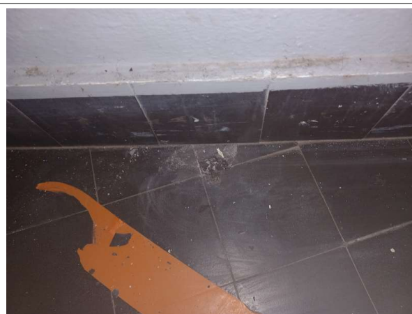
Prélèvement - P022 : MAISON D'ARRET / R+1 / ATTENTE PARLOIRS DETENUS - Colle de carrelage- (Absence d'amiante)
